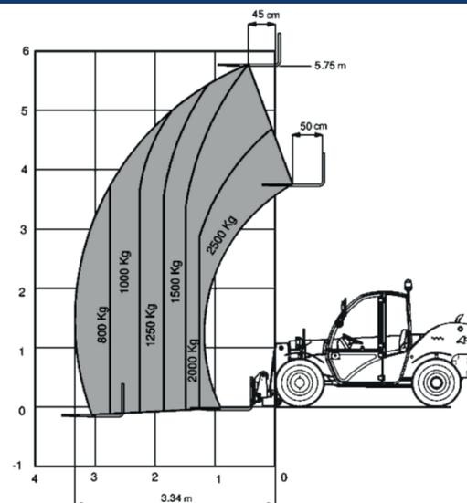
Diagramma di carico con forche rotanti
